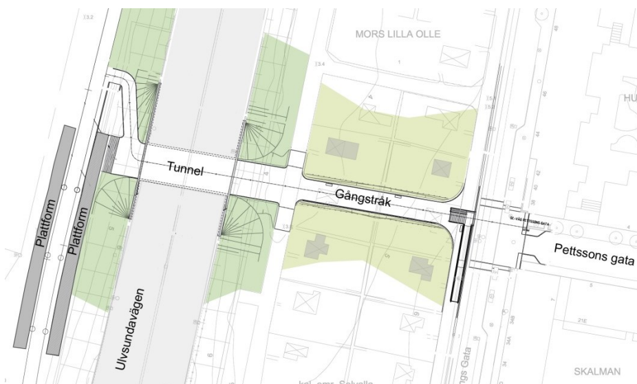
Figur 4. Illustration över sträckning och utformning av förbindelse mellan Annedal och hållplats Solvalla
