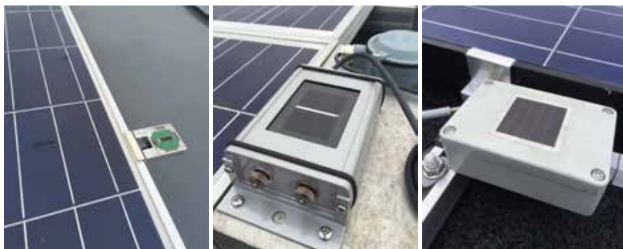
Exempel på tre solinstrålningsgivare som använts i projektet.
