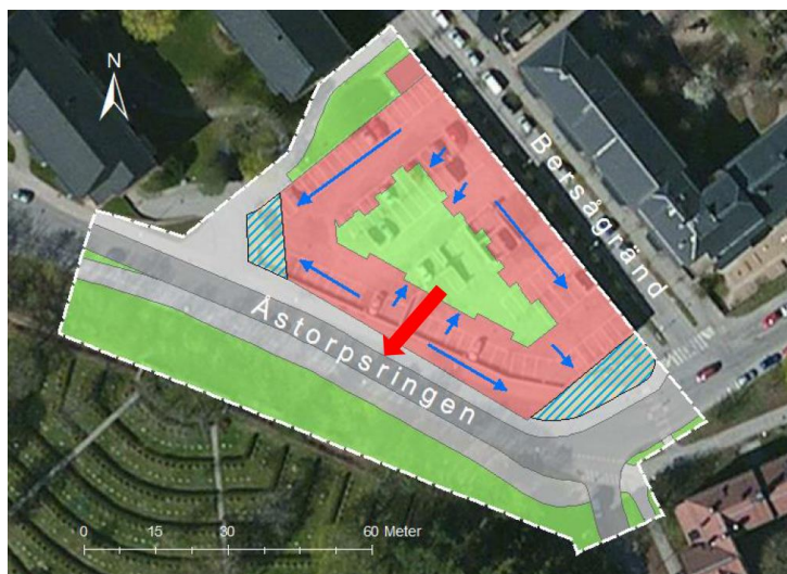
Principskiss som redovisar ungefärlig placering av makadammagasin (blåstreckad yta). Röd pil visar yttlig avrinningsväg för dagvatten genom portiken vid extremregn. Bild från dagvattenutredningen.
