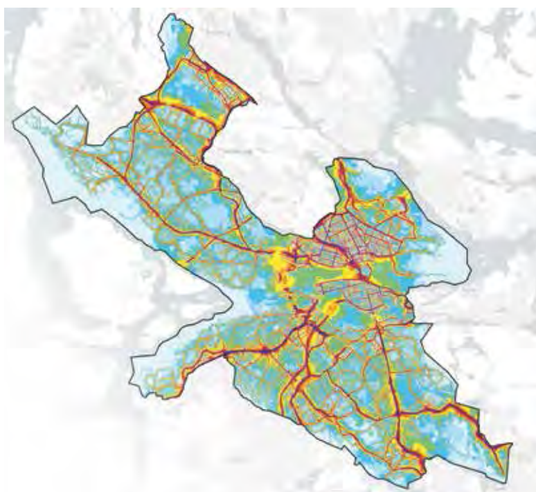
Beräknade bullernivåer från väg- och järnvägstrafik, dygnsmedelvärde
