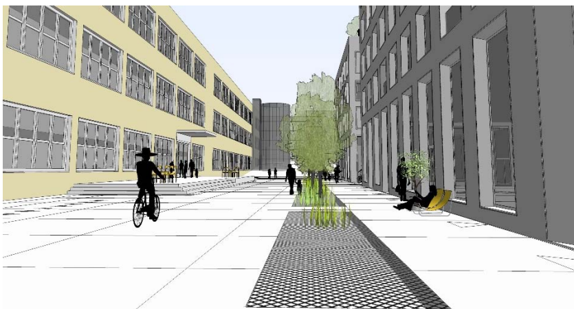
Konstfacksgångens föreslagna utformning med planteringsbäddar för fördröjning av dagvatten fungerar också som gräns mellan privat och offentligt Illustration / White arkitekter
