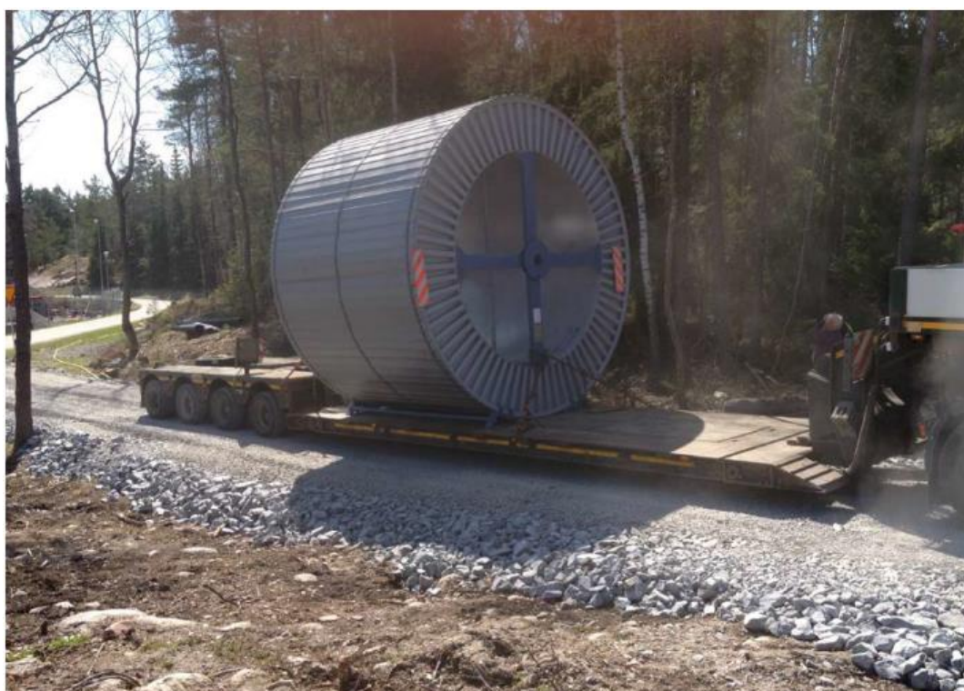
Figur 8. Exempel på transportekipage av kabeltrumma. Foto: FRECC
