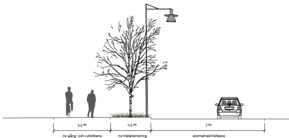
Principsektion ny utformning av Gamla Skärgårdsvägen Skala 1:100
