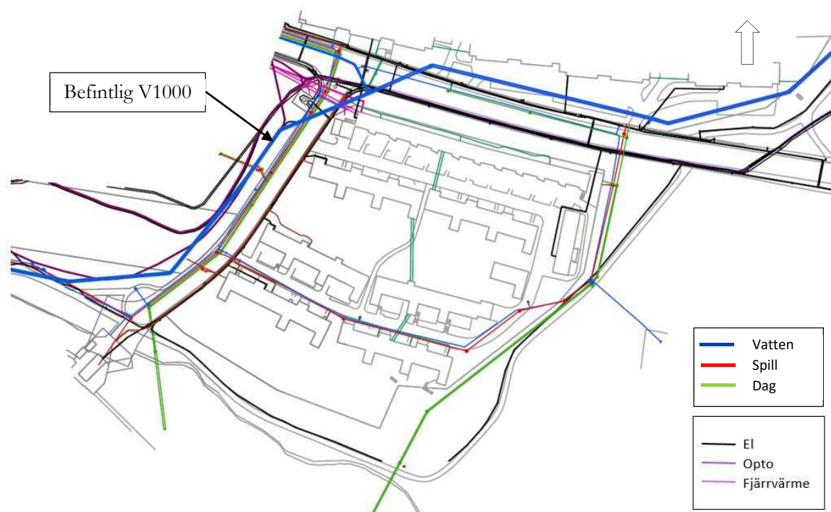
Figur 6 Befintliga ledningar och kablar inom utredningsområdet.
