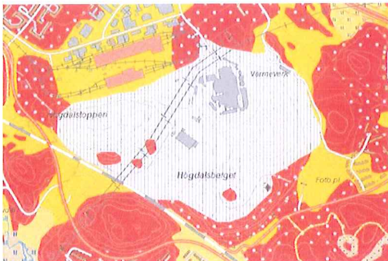
Karta över jordarterna i närområdet. De röda områdena representerar berg i dagen, de gula lera och de gråstreckade fyllnadsmassor. (Sweco)
