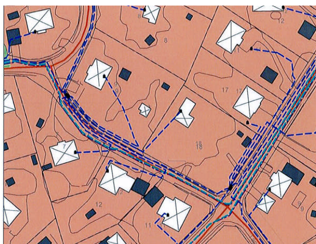
Vattenfalls elanläggningar: Turkos linje= 24 kV högspänningsledn. blå linje= 0,4 kV lågspänningsledn. och lila linje=0,1 kV styrkabel.
