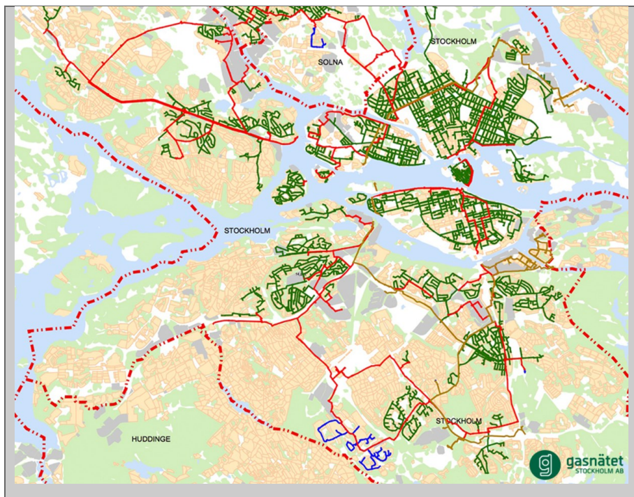
Figur 10; Stadsgasnätet (grönt visar lågtryck, blått mellantryck och rött högtryck), och Fordonsgasnätet (orange). Källa: www.gasnätetstockholm.se
