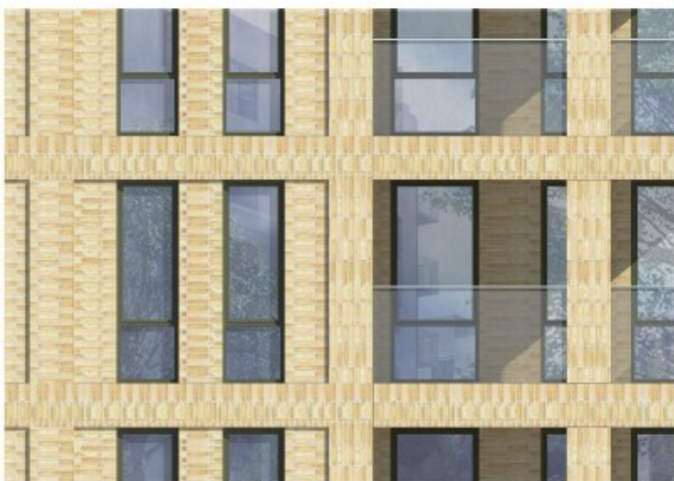
Fasadutsnitt, murning, detaljer, reliefer, balkonger. (AIX Arkitekter)
