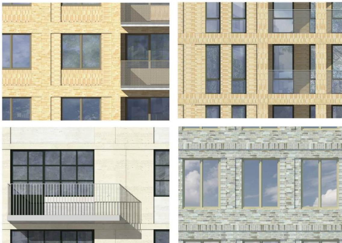
Fasadutsnitt, murning, detaljer, reliefer, balkonger (AIX Arkitekter)
