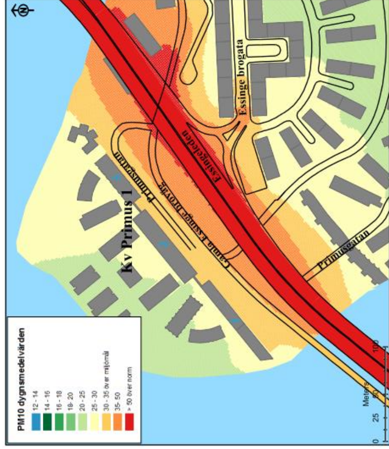
Figur 30 PM10 µg/m 3 dygnsmedelvärden, utbyggnadsalternativet med skärmar år 2023. Miljö kvalitetsnorm 50 µg/m 3 . Miljömål 30 µg/m 3 .
