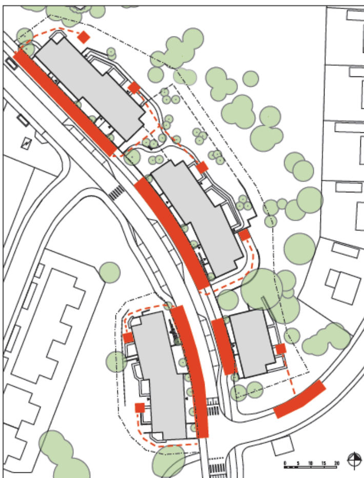
Förslag på lösningar vid brandutryckning. Lång röda yta visar möjliga uppställningsplatser för brandbil, kvadratisk röd yta visar plats för brandstege och röd streckad linje visar var man till fots når plats för brandstege.
