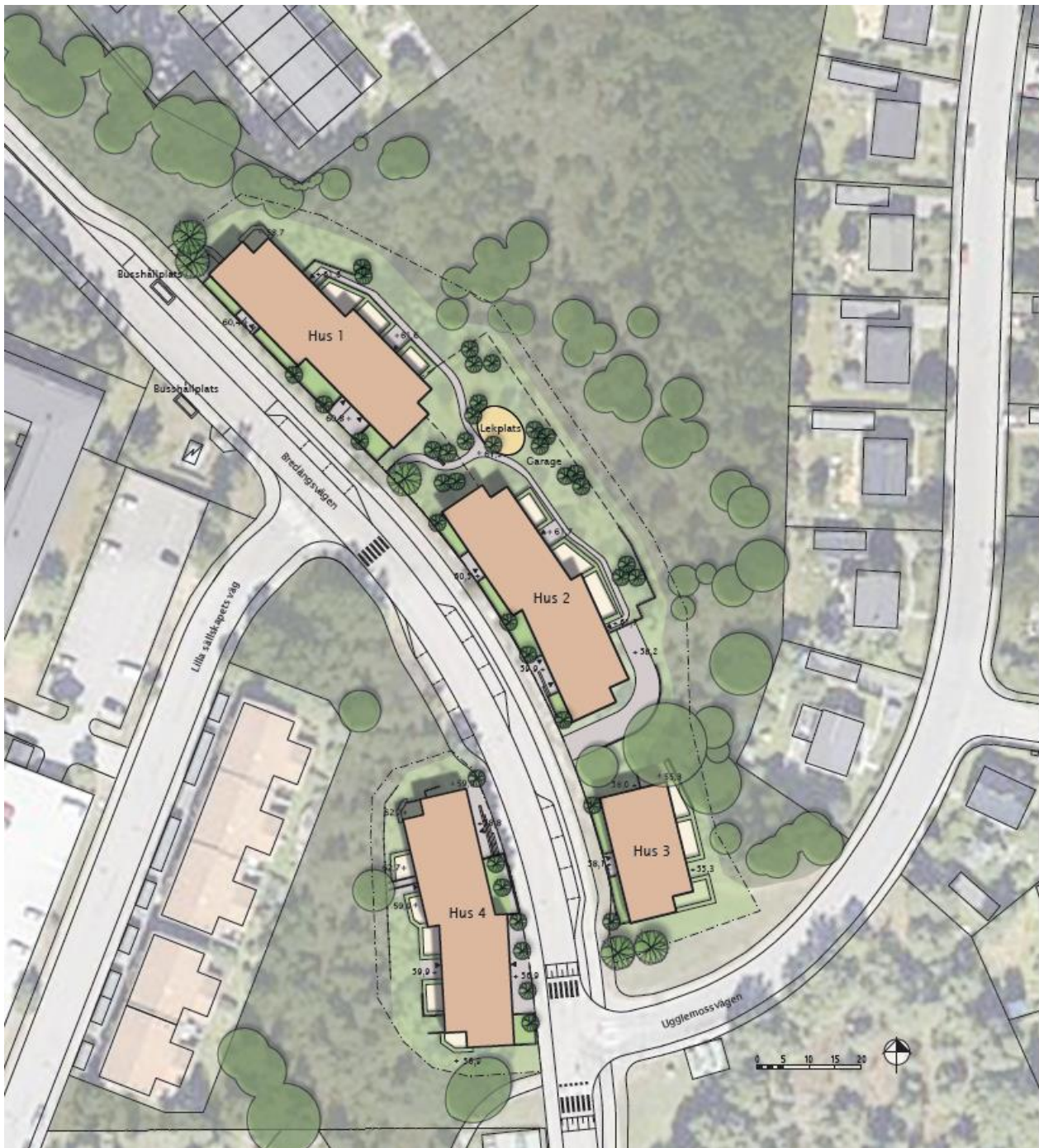
Situationsplan över de fyra föreslagna byggnadskropparna tillsammans med föreslagen ombyggnad av Bredängsvägens sektion. (Thyréns)
