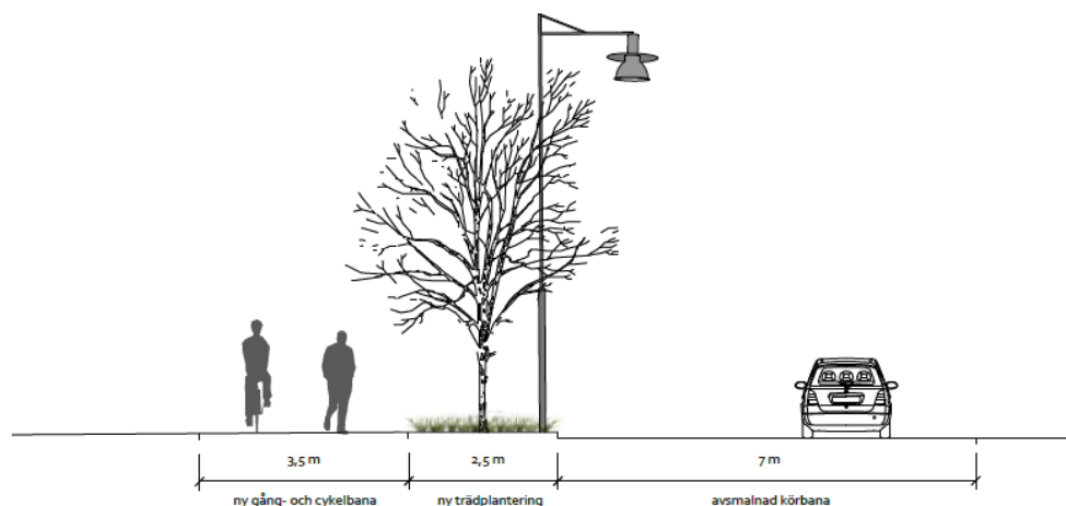
Principsektion ny utformning av Gamla Skärgårdsvägen Skala 1:100
