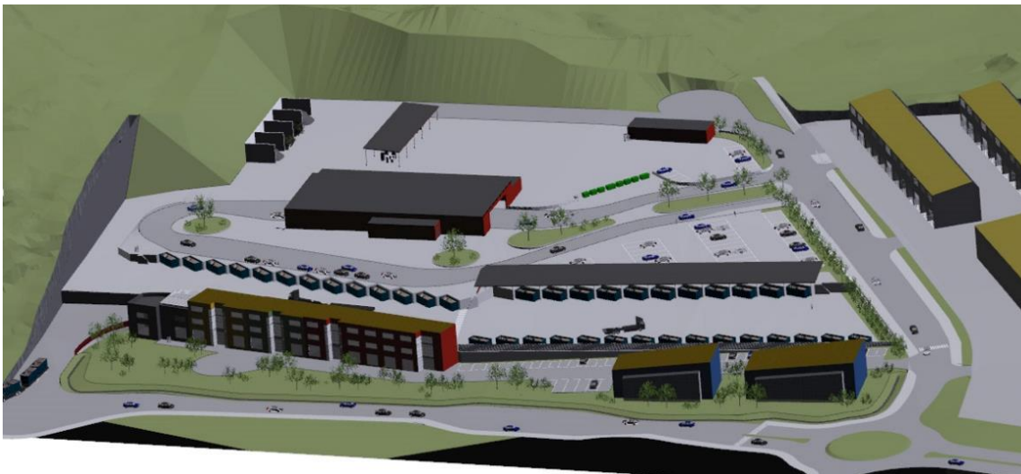
Fig. 2 Förslag på utformning för kretsloppscentralen (KLC). KLC:n anläggs i tre nivåer med en återbruksdel närmast väg 622, gamla Skärgårdsvägen.
