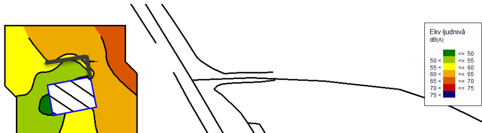
Figur 7.5 Ekvivalenta ljudnivåer 1,5 m ovan mark med ett 2 m högt bullerplank (beräkningspunkt 5).
