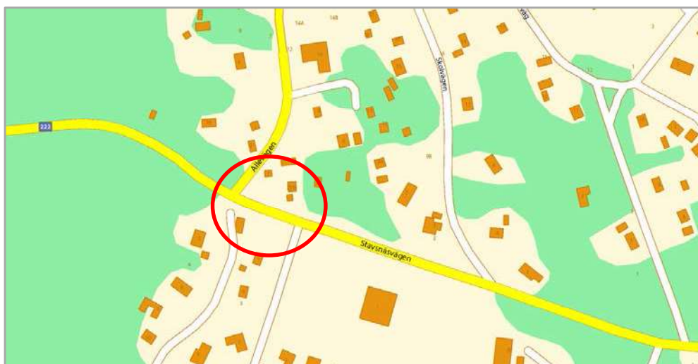
Figur 3-24 Förslag på att utreda om korsningen mellan Allévägen och Storskogsvägen kan utformas som en cirkulationsplats med Stavsnäsvägen i centrala Stavsnäs
