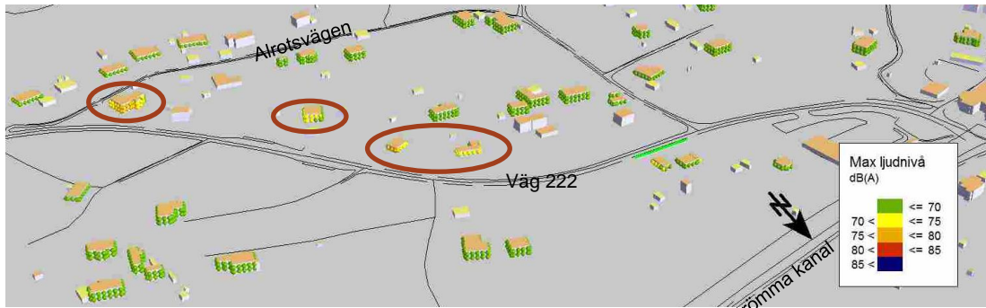
Figur 6.12 Maximala ljudnivåer vid fasad på sträckan norr om Alrotsvägen sett från norr. Inringat överskrider riktvärde på våning 1.
