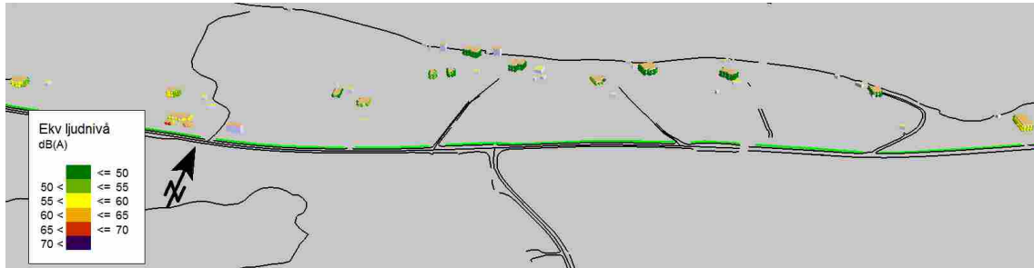
Figur 7.3 Ekvivalenta ljudnivåer vid fasad med 2 m högt bullerplank på norra sidan av väg 222
