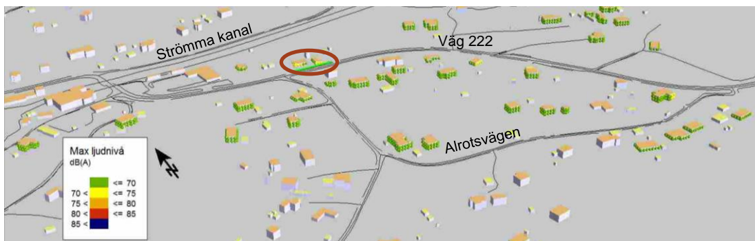
Figur 6.11 Maximala ljudnivåer vid fasad på sträckan norr om Alrotsvägen sett från söder. Inringat överskrider riktvärde på våning 1.
