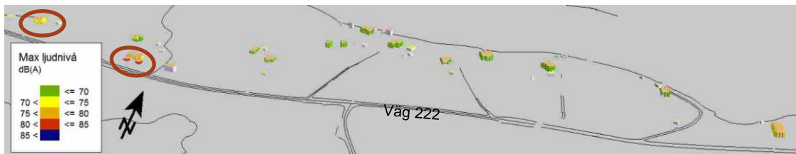
Figur 6.13 Maximala ljudnivåer vid fasad på sträckan öster om Alrotsvägen sett från söder. Inringat överskrider riktvärde på våning 1.
