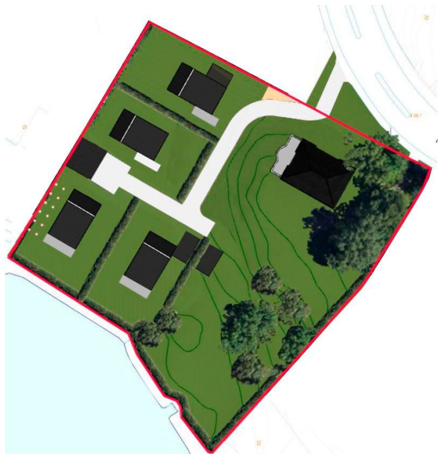
Bild 1. Illustrationsplan med nya fastigheter. Exempel på placering av byggnader. Röd linje visar på befintlig tomtgräns. (källa: planbeskrivningen) Den större byggnaden till höger är befintlig.
