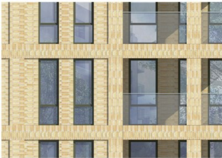
Fasadutsnitt, murning, detaljer, reliefer, balkonger. (AIX Arkitekter)
