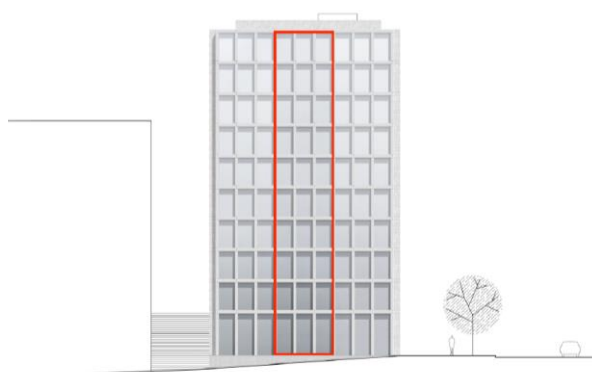
Hus 2, gavelfasad mot Huvudstråket respektive Parkstråket. Röd markering redovisar ett exempel på hur del av fasaden kan utformas med vanliga glasytor. Övriga delar utformas med så kallat Blindglas. Bild: Johannes Norlander Arkitektur
