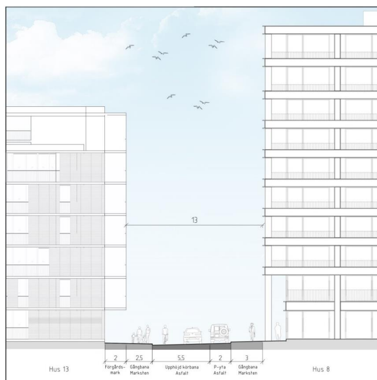
Sektion genom den nya lokalgatan. Bild Sweco
