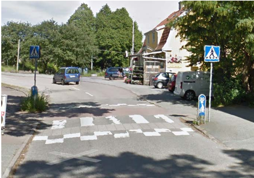
Figur 6-3 Exempel på passage med förhöjning. Långedragsvägen, Göteborg
