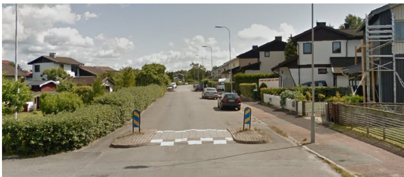
Figur 6-2 Exempel på passage bredvid förhöjning. Utmarksgatan, Göteborg
