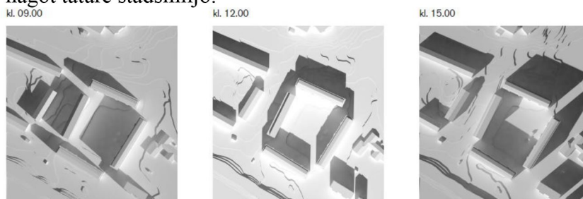
Utdrag ur solstudien för kvarter vid Dillö 20 mars. Vid 9-tiden skuggas bebyggelsen vid Lurö och vid 15-tiden skuggas lamellhuset norr om föreslagen byggnad delvis. Vid övriga tider skuggas inte befintlig bebyggelse. Joliark.
