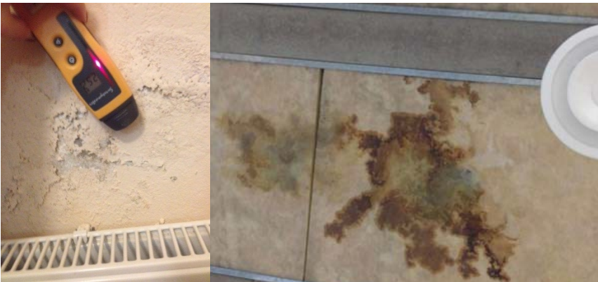
Figur 2 & 3. Exempel från tillsynen - Misstänka fuktskador i en skola (fig. 2) och i en förskola (fig. 3). I figur 2 syns hur instrumentet indikerar fukt när den röda lampan lyser.
