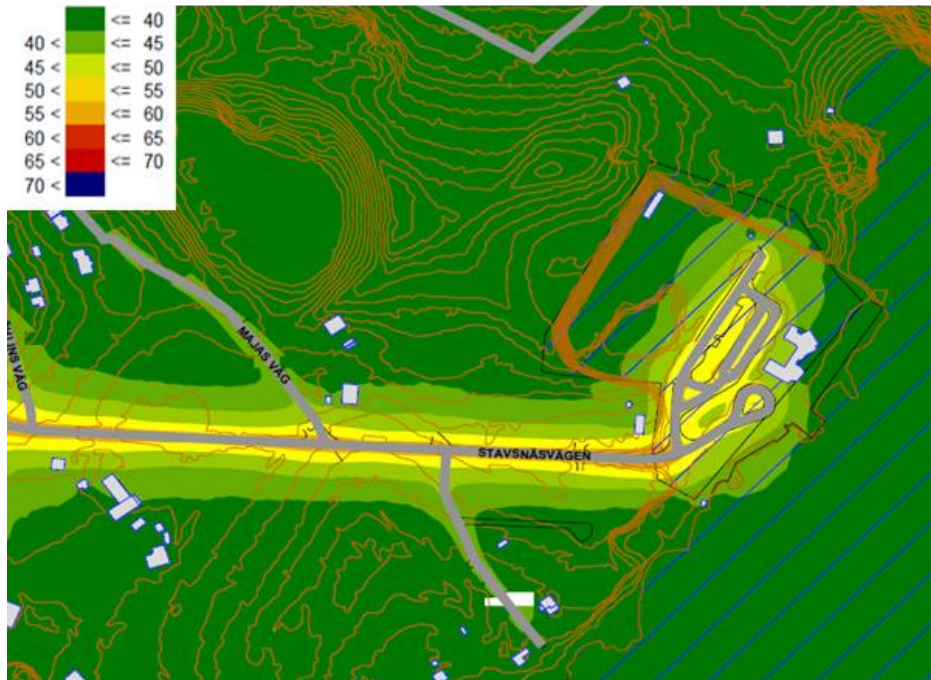
Figur 12. Ekvivalenta ljudnivåer i markplanet (2 m ovan mark) – vägtrafik, ljudnivåer enligt dagens trafikmängd (Akustikbyrån, 2016).
