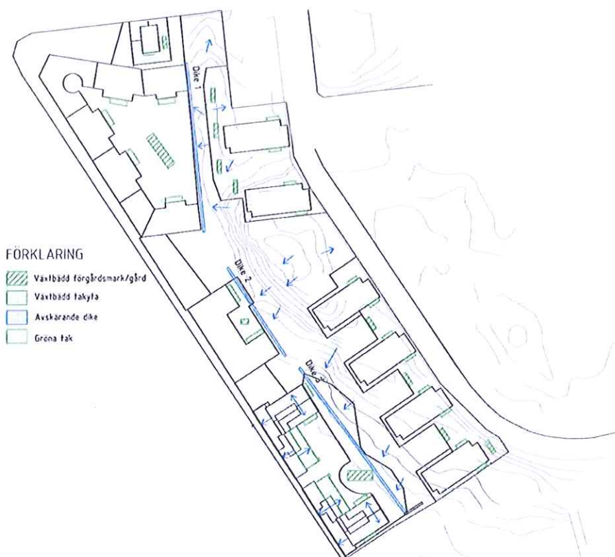
Förslag till dagvattenhantering inom kvartersmark (WSP, 2017-11-16)
