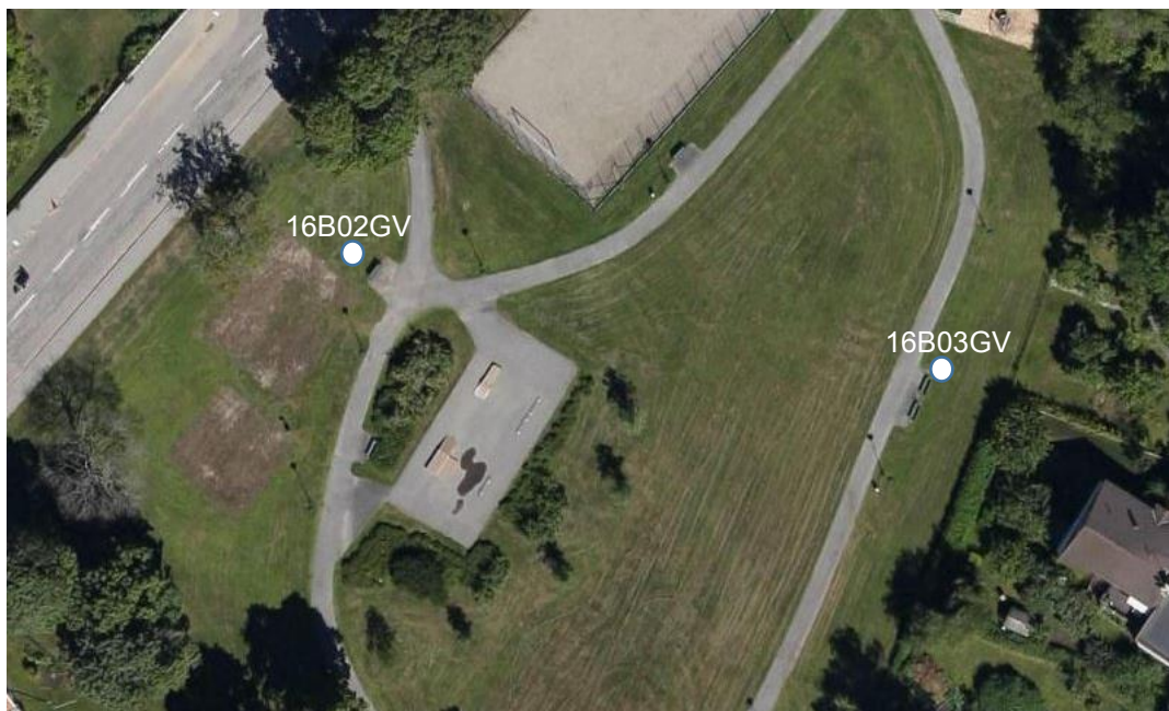
Figur 8.1: Grundvattenrör som installerades i samband med den aktuella undersökningen vid Bergtorpskärret.
