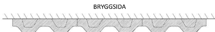
Figur 6. Plan av brygga med vågformad fender
