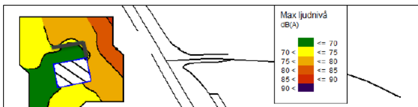
Figur 61 Maximala ljudnivåer 1,5 m ovan mark med ett 2 m högt bullerplank, Strömma 4:9
