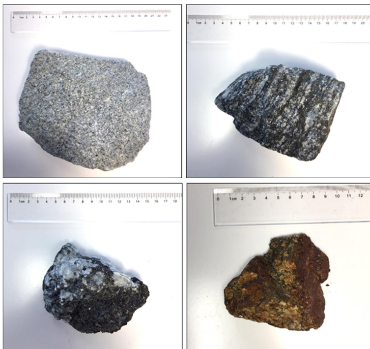
Figur 6. Representativt urval av insamlade bergprover vid inventering 2017. A – Massiv, medelkornig granit. B – Slirig, ojämnkornig sedimentgnejs. C – Grovkornig pegmatit, biotitrik. D – Pegmatit med rost- och sulfidutfällning.
