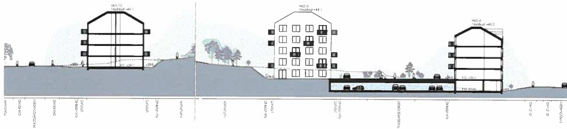
SEKTION C-C Sektion genom punkthus samt genom parkeringsgarage och lamellhus som ligger närmast Tyresövägen.
