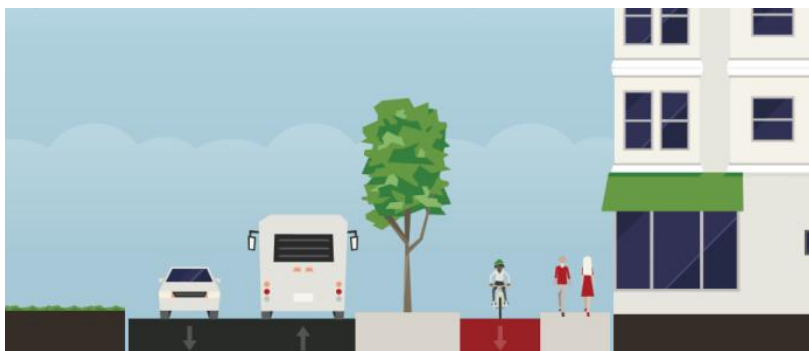
Principsektion Prästgårdsvägen, vy från söder (13,8 m): Körbana (6,5 m), yta för lämnning och uppställning av sopbil (3,0 m), GC-väg (2,3 m) och gångbana (2,0 m). Källa: Tyresö kommun 2018, Streetmix©
