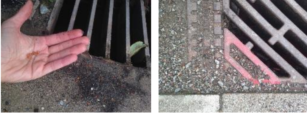
Till vänster lösa granulatbitar intill dagvattenbrunn på lekplatsen Kaninparken och till höger på lekplatsen Metronomgatan. Bildkälla: Sofie Lindgren
