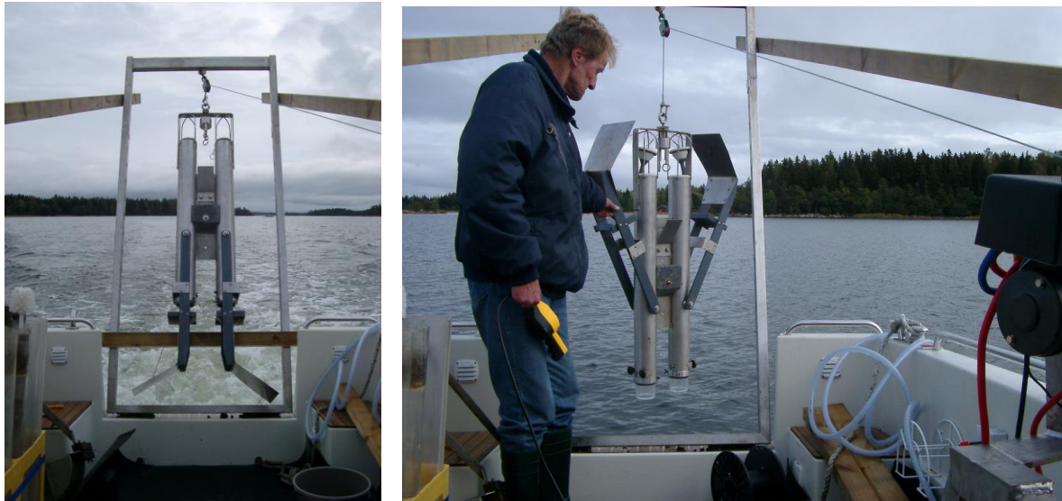
Figur 6 Vänstra bilden: Gemini-hämtaren surrad för transport. Högra bilden: Geminihämtaren laddad och redo för hugg.
