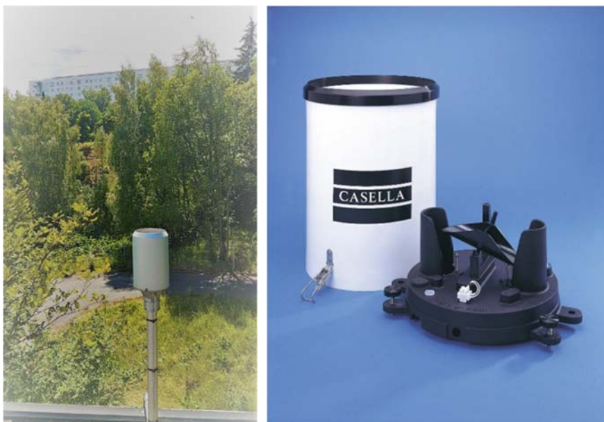
Figur 5. SVOAs nederbördsjätmare för automatisk nederbördsjätmning med skydd till vänster och tipping-bucket till höger. Bilder från SVOA.
