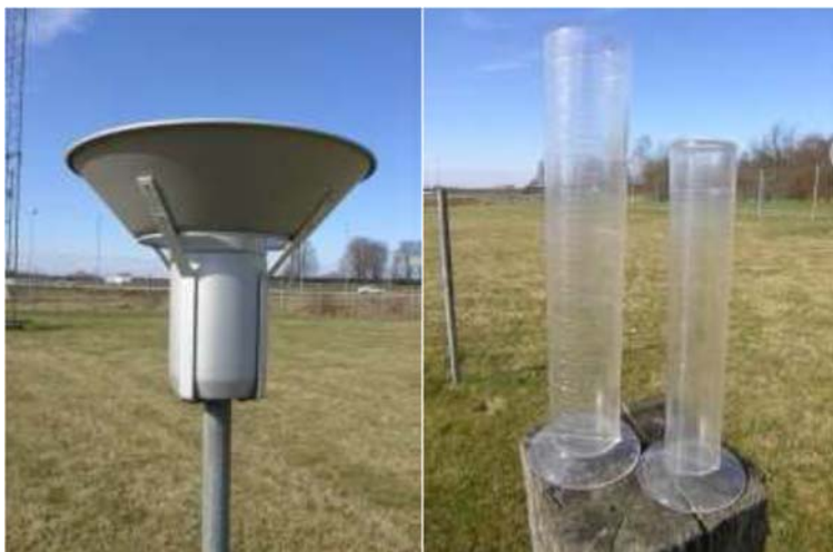
Figur 2. Traditionell nederbördsjätmare med vindskydd typ nipher för manuell nederbördsjätmning till vänster och mätklas för att mäta mängden nederbörd till höger. Bilder från SMHI.
