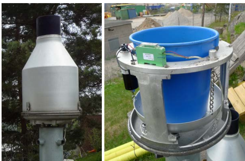
Figur 3. Högdalens nederbördsjätmare för automatisk nederbördsjätmning med skydd till vänster och mätkärlet upphängt i kedjor samt givare till höger. Bilder från SLB-analys.
