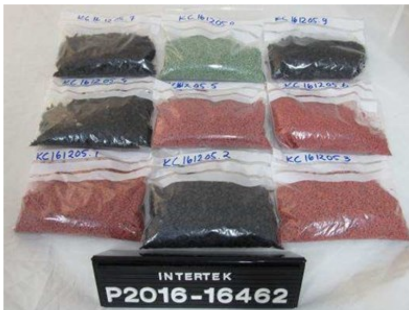
Figur 1 - Analyserade prover av SBR och EPDM gummigranulat 2016.
