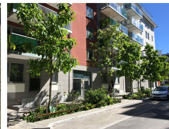
Exempel på träd som planteras i nedsänkta, sammanhängande växtbäddar med skelettjord.
