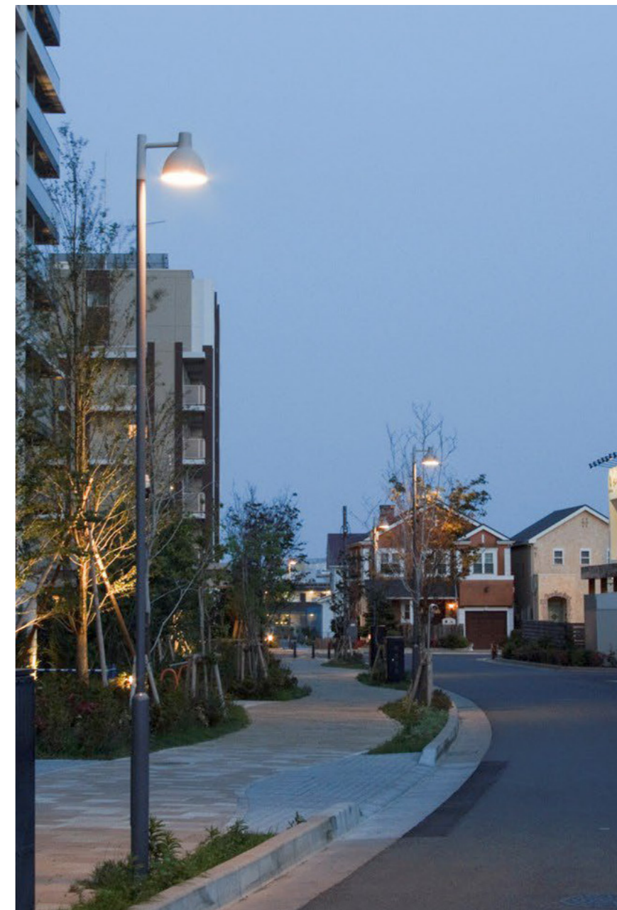
Exempel på armatur och stolphöjd som passar i gaturummets skala. Eventuellt med dubbelarm för armatur på lägre höjd mot gångbana. Louis Poulsen.
