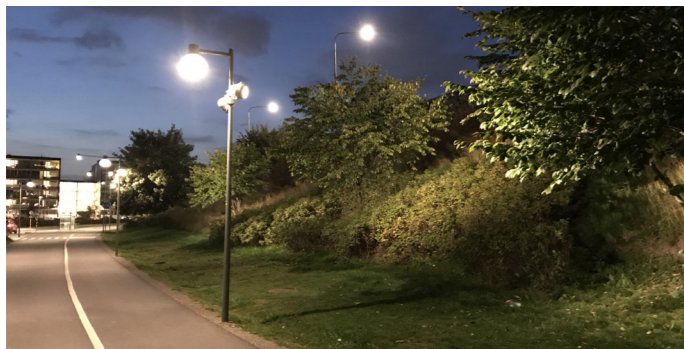
Exempel på hur spotlights på belysningsstolpar som riktar mot vegetation förstärker det upplysta rummet och ökar upplevelsen av trygghet.
