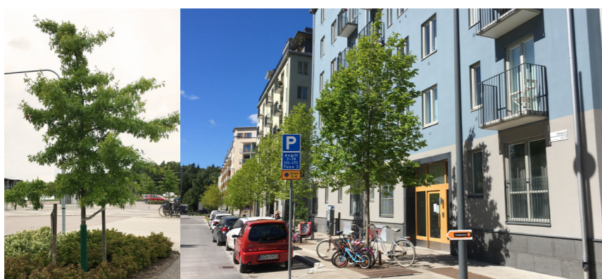
Exempel på trädplantering i sammanhängande växtbädd som både tar ner skalan på gaturummet och hanterar dagvatten.
