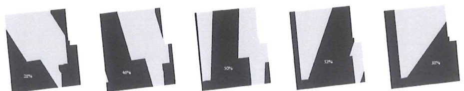
Ljusförhållanden på Bredholmstorget vid vår- och höstjämning från kl.10:00-15:00. Högst effekt ses vid kl. 11:00 (43%), kl.12:00 (49%) och kl.13:00 (37%)
