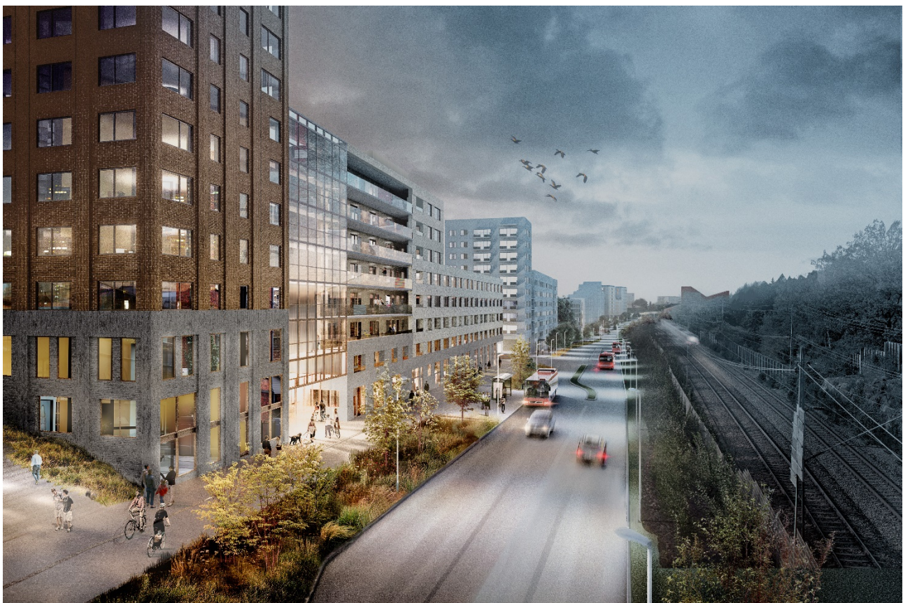
Visionsbild för Magelungsvägen, sedd från Nykroppagatans bro mot Fagersjö. Magelungsvägen byggs om till gata med stadskaraktär där en separerad gång- och cykelbana kantas av regnträdgårdar, dvs planteringar för dagvattenrening- och fördröjning. Nya busshållplatser tillkommer. Till vänster leder en trappa upp till Nykroppagatan. Illustration White/Stadsbyggnadskontoret.
