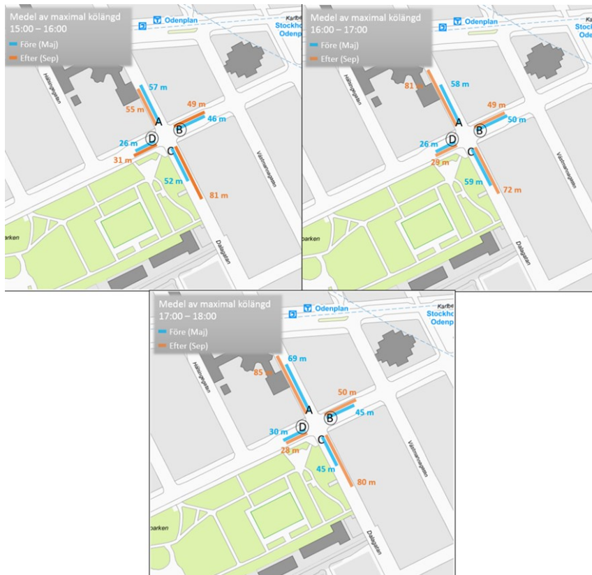
Figur 10. Medelvärde av maximal kölängd av varje femminutersperiod för respektive timme under 15.00-18.00 för korsningen Dalagatan/Odengatan. Före- och eftermätning. Kölängder i personbils ekvivalenter, där en personbil motsvarar 7 meter. I tillfart B och D har justeringar gjorts i trafiksignalerna.
