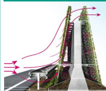
Skärm med växtvagnar, murgröna och dess effekt på partiklar Bild : Green4roads
