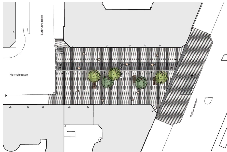
Figur3. Illustration av ny utformning av Norrtullsgatan mellan Karlbergsvägen och Surbrunnsgatan, som en bilfri torgyta med träd och sittmöbler samt separerad cykelbana.
