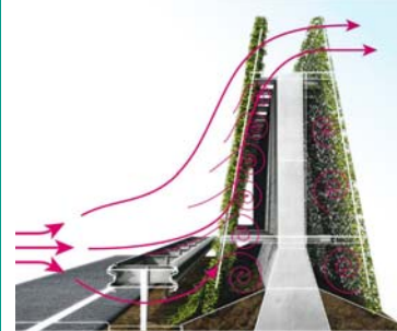
Skärm med växtvagnar, murgröna och dess effekt på partiklar Bild : Green4roads
