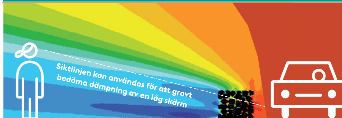
Beräknad ljuddämpning av en gabionmur. Illustration har lagts till. Bild: HOSANNA [8]
