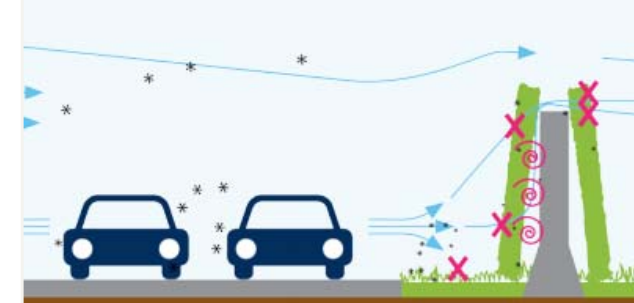
Skärm med växtvagnar, murgröna och dess effekt på partiklar Bild : Green4roads
