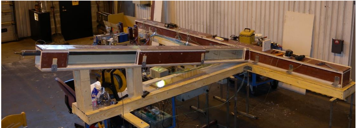
Figur 1 En modell av en tunnel under byggnation. Den lutande rampen används för att komma ner till två arbetstunnlar. Arbetstunnlarna är stängd i ändarna (stuppen) fram till dess genombrott sker. Foto: RISE.
