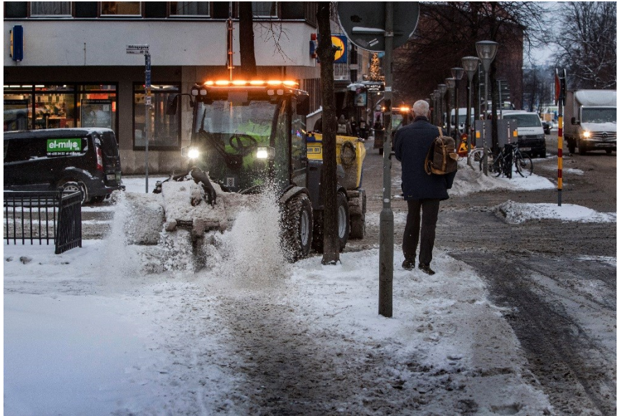
Gångbanemaskin genomför sopning och saltning av trottoar i en komplex miljö med många hinder.
