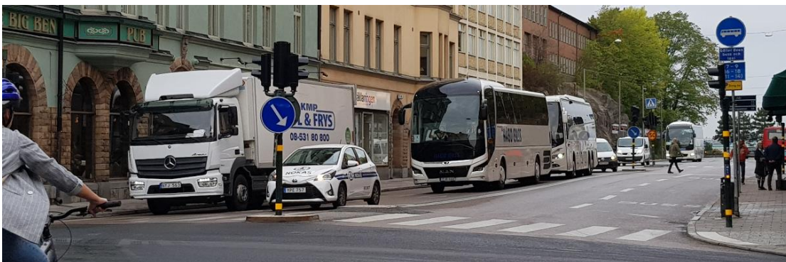
Figur 3. Beställningstrafik som inför högersväng mot Folkungagatan och Medborgarplatsen är placerad i vänster körfält vilket tyder på att svängraden är för snäv från höger körfält.
