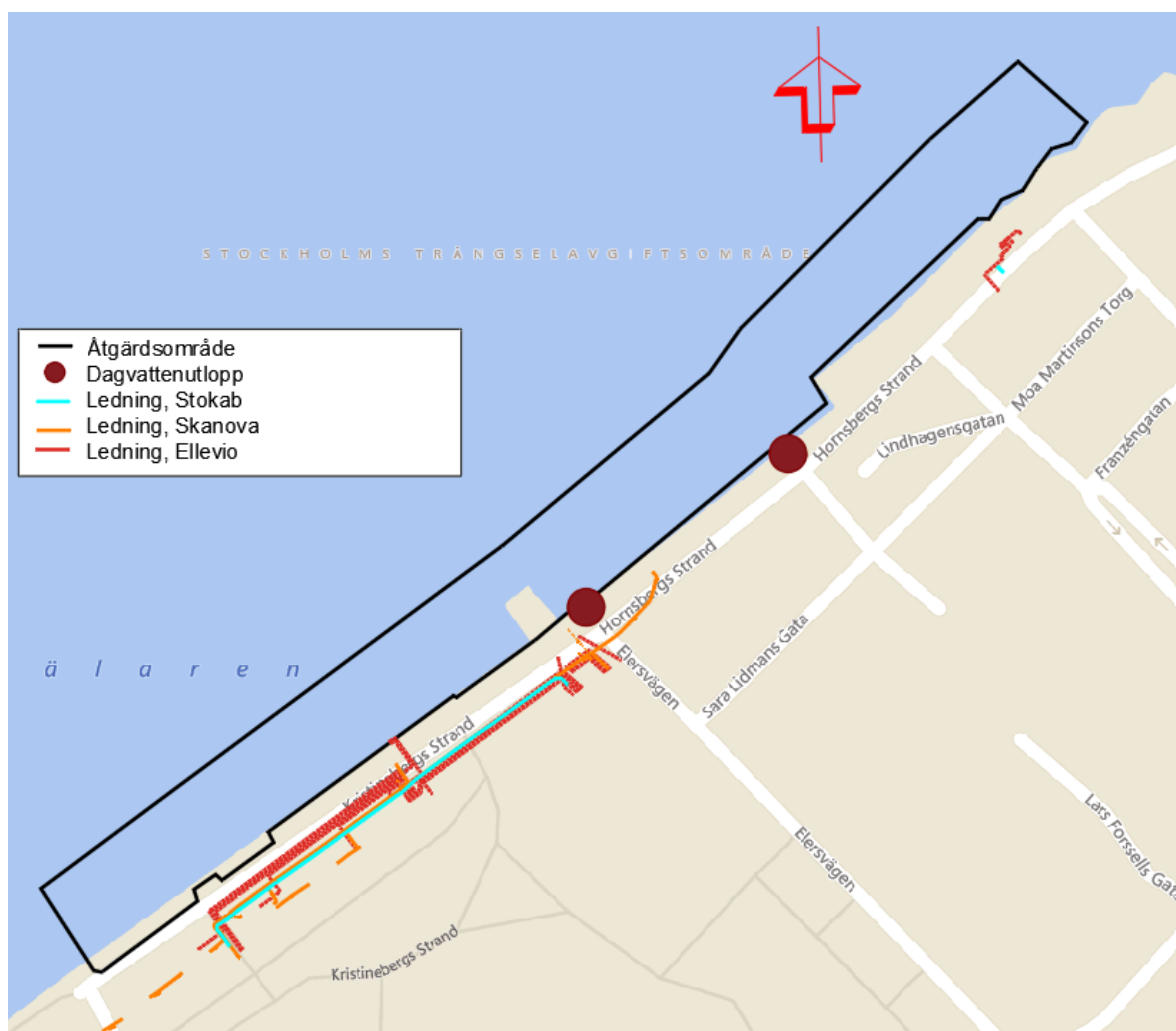
Figur 40. Ledningar och dagvattenutlopp utanför och på gränsen till åtgärdsområde för åtgärd 11, Risvasar vid Kristinebergs strand.
