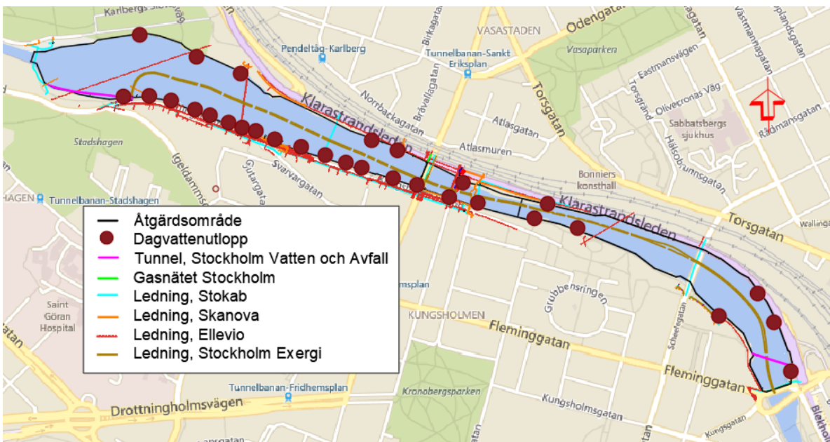
Figur 44. Ledningar och dagvattenutlopp i åtgärdsområde för åtgärd 12, Risvaror vid Karlbergssjön och Barnhusviken.
