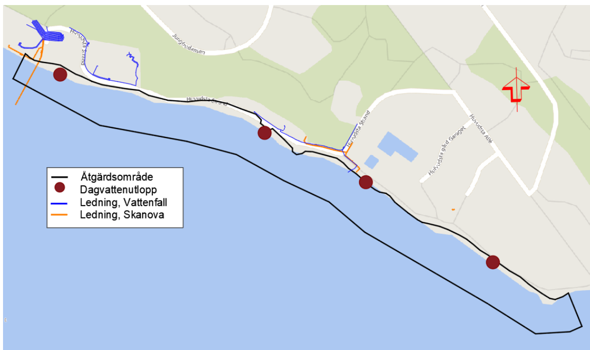
Figur 36. Ledningar och dagvattenutlopp i och omkring utredningsområde för åtgärd 10, Risvasar vid Huvudsta strand.
