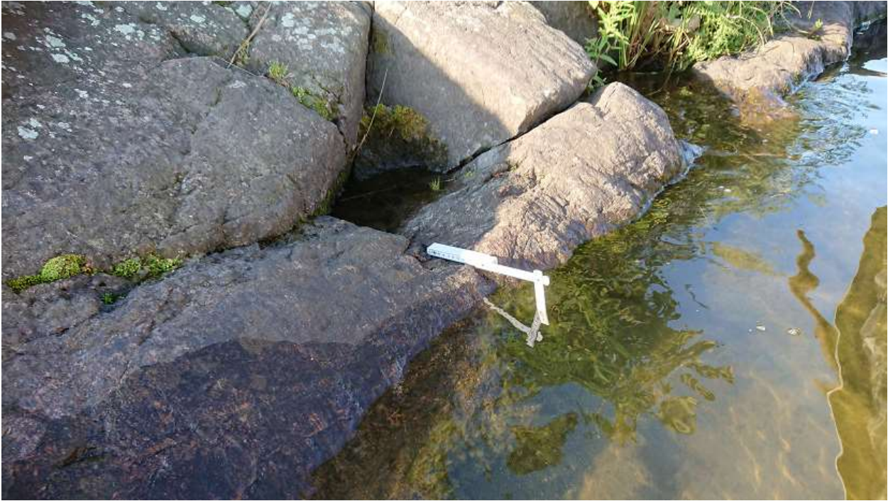
Magelungen: vattenståndet mättes in mot avsats vid håll. Vattenståndet var 7,5 cm högre vid årets inventering, jämfört med senaste inventeringen (2009).
