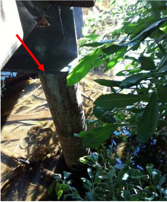
Kyrksjön: vattenståndet mättes in mot underdelen av metallfäste på brygga. Bilden är från inventeringen 2014 och vattenståndet var 10 cm lägre vid årets inventering.
