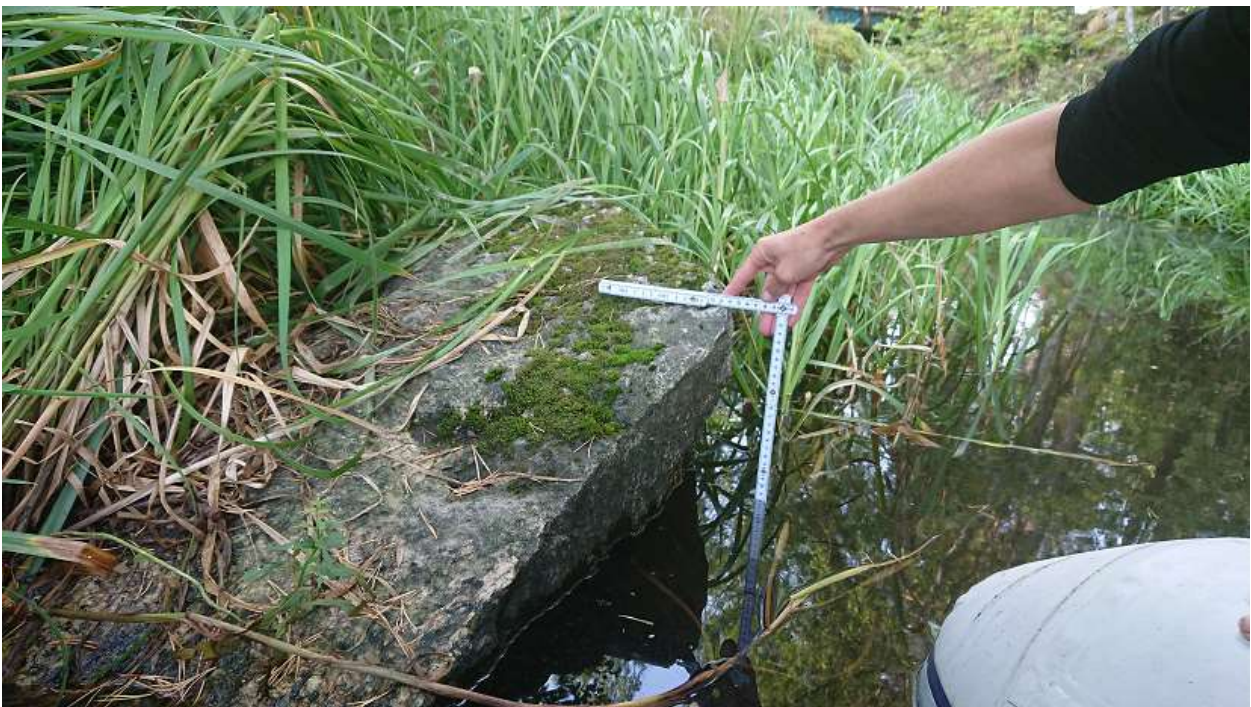
Räcksta träsk: vattenståndet mättes in mot hörn på block vid utlopp.
