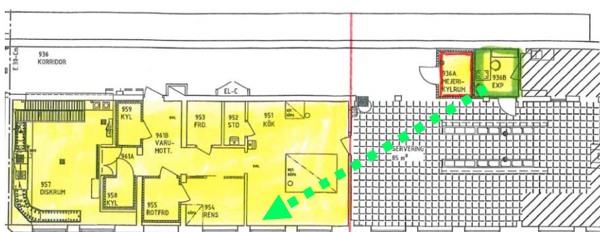
Bild 2: Nuvarande planlösning. Köket till vänster och matsalen till höger (det är endast den främre delen av matsalen som syns här). Kylrummet i matsalen ska rivas ned. Likaså kontoret. Kontoret ska ersättas med ett nytt kontor inne i köket.
