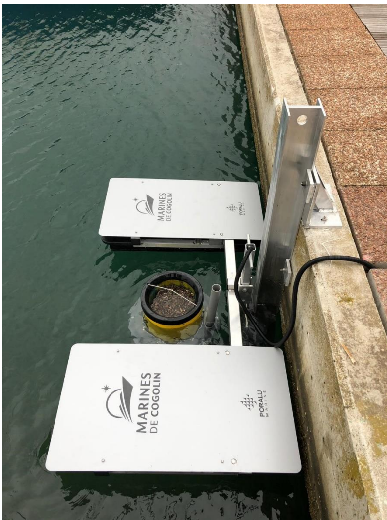
Figur 6 Seabin monterad på kaj med flytande pontoner på respektive sida om fästeanordningen (Bildkälla: Nicholas Eriksson, 2019)
