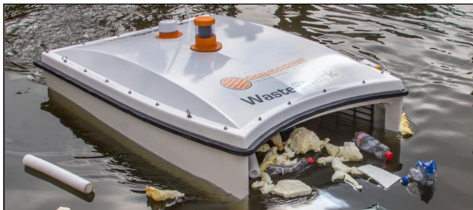
Figur 7 Den skräpätande, vattenburna roboten WasteShark. (Bildkälla: RanMarine, 2019)
