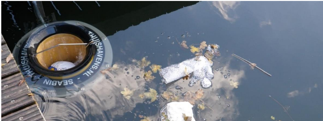
Figur 3 En Seabin med oljepod installerad vid en brygga. (Bildkälla: The Seabin Project, 2019)
